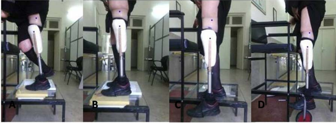
Fig. 1) The 4-stage Static Test. (A) FWB; (B) SWB; (C) NWB; (D) 30N Loading
